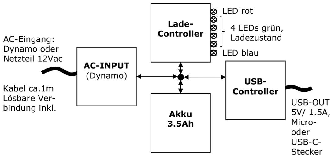
Bild 2: Harvester-Funktion
