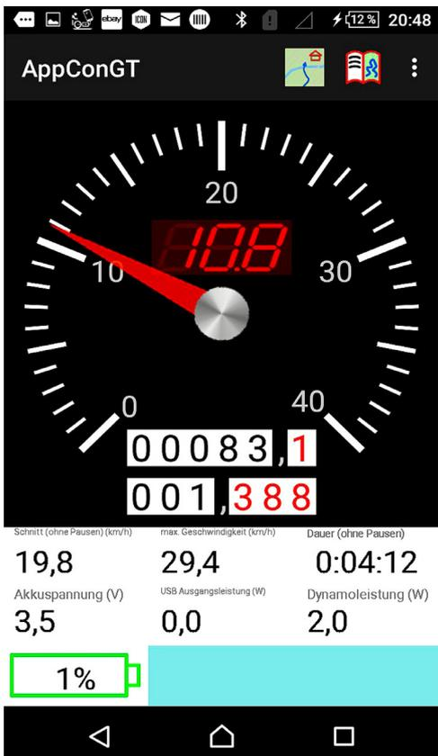
Bild 20: Die «Appcon GT»-App bietet neben der hier gezeigten Tacho-Ansicht auch eine einfache Navigati-on, bei der GPX-Tracks angezeigt werden können.
