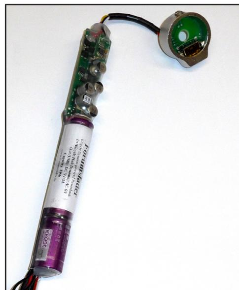
Bild 5: »Forumslader V5 Ahead« von Jens During – angeboten als Bastel-Kit oder in Wunschkonfiguration individuell vom Hersteller aufgebaut. Hier getestet in der Version zum Einbau in den Gabelschaft.
