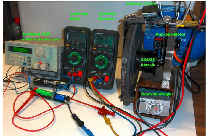
Bild 12: Prüfstands-aufbau mit angetriebenem Nabendynamo, Leistungsmessgerät und elektronischer Last.
