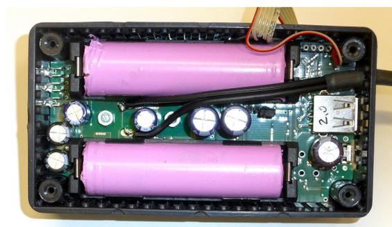
Bild 8: »USB-P5« offen. Dies ist ein Prototyp mit für uns herausgeführten Mess-Leitungen. Der Käufer hat hier stets vollen Zugang zu Elektronik und Akkus. Das Nachrüsten von Zellen mit noch höherer Kapazität ist einfach möglich.
